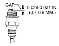
Figure 21. Spark Plug Gap
